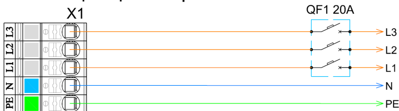
Рис. 6 Схема подключения дополнительного оборудования. Цепи AC220В
